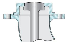
Auf / Zu Flachkegel, (VBA) aus dem Kessel öffnend
