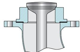
Auf / Zu Flachkegel, (VBJ) in den Kessel öffnend
