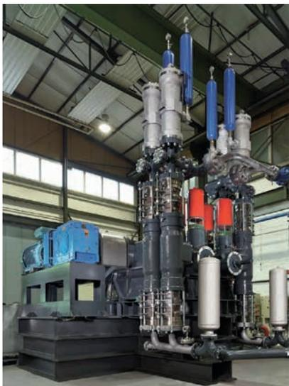
Die vierköpfige MULTISAFE-Pumpe auf dem werkseigenen Prüfstand.
