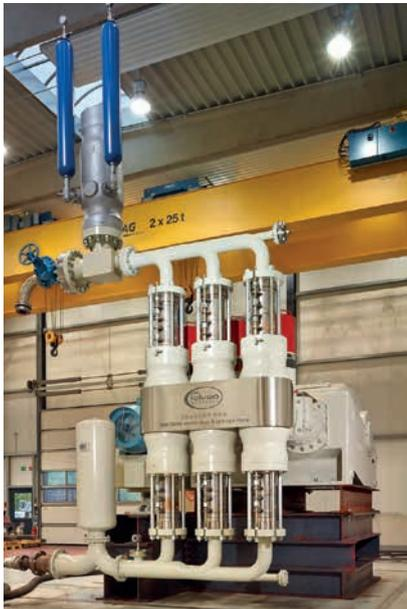
Die MULTISAFE-Pumpe in Triplex-Ausführung mit Hubgetriebe der Baureihe TGK 500/400 beim Testlauf.
