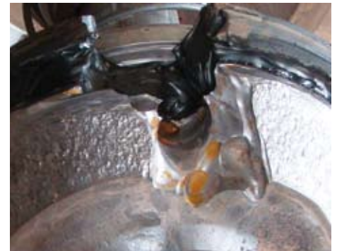
▲ Zu spät erkannter Ventilverschleiß Late recognition of wearing check valves
