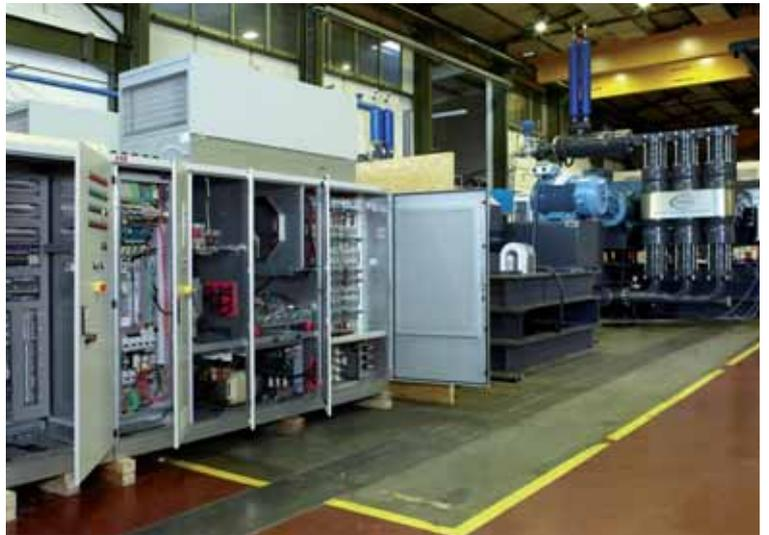
▲ MULTISAFE Doppel-Schlauchmembranpumpe mit Mittelspannungs-Technologie
